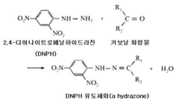
그림 1. 다이나이트로페닐하이드라진 (DNPH) 유도체 반응식
